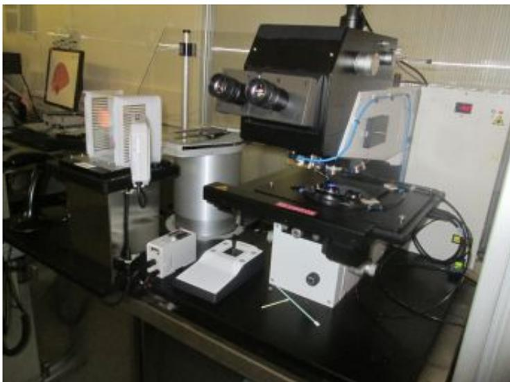
**Inspektion** von Masken, die zur Erzeugung von Wafern eingesetzt werden.
