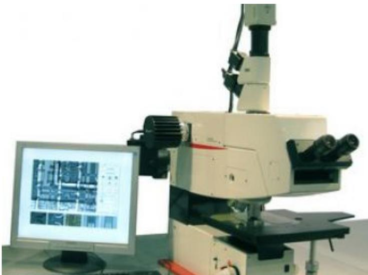
Mess- und Inspektionsmikroskop mit multispektraler Konfiguration. Das INM200 überzeugt mit höchster optischer Leistungsfähigkeit, schneller, einfacher Bedienung und Ergonomie für ermüdungsfreies Arbeiten über Stunden.
